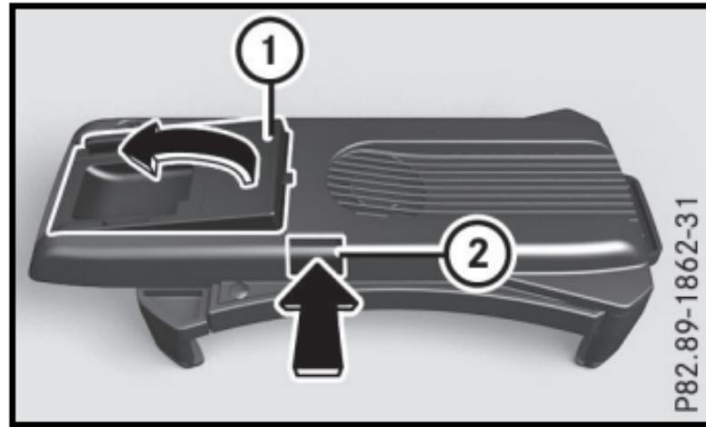
Se a consola para smartphone estiver instalada no veículo numa posição vertical, é possível ajustar o ângulo de alinhamento para um melhor manuseamento.
