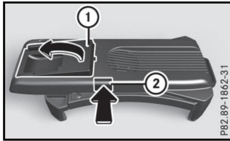
Ha az okostelefon-bölcső a járműben függőlegesen van beszerelve, akkor a dőlésszög a jobb kezelhetőség érdekében átállítható.
