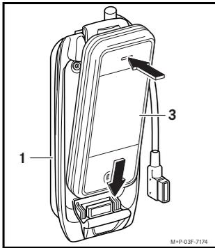
1. Mobiltelefon (3) auf den Stecker des Halters (1) aufsetzen und mit leichtem Druck oberhalb des Displays in den Halter führen, bis es hörbar einrastet.
