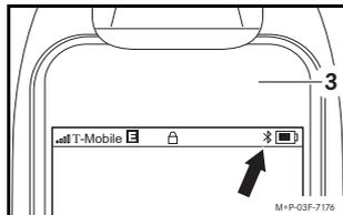
Im Display des Mobiltelefons erfolgt ein Farbwechsel des Bluetooth®-Symbols (Pfeil) von grau nach weiß. Ist dies nicht der Fall, Mobiltelefon (3) entnehmen und erneut einsetzen.
