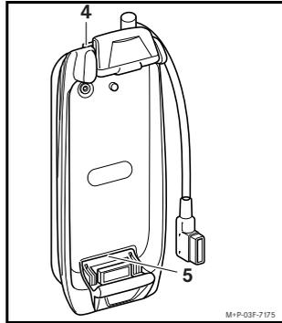
2. Bluetooth®-Taste (4) ca. 2 Sekunden drücken. Die Leuchtdiode (5) blinkt in schneller Frequenz. Der Halter ist ca. 2 Minuten für suchende Geräte sichtbar und kann vom Mobiltelefon erkannt werden.
