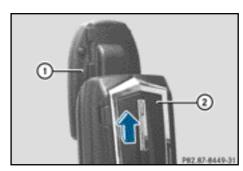
► Inserte el módulo de teléfono ② en el alojamiento ① hasta que se enclave de forma audible.
