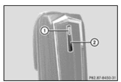
► Pulse la tecla ② y manténgala pulsada. El testigo de control ① se ilumina en blanco.
