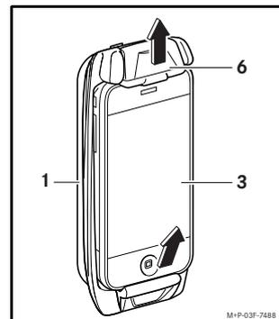
1. Verriegelung (6) nach oben schieben, und Mobiltelefon (3) aus dem Halter (1) nehmen.
