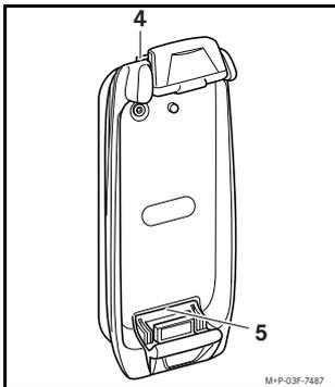
2. Bluetooth®-Taste (4) ca. 2 Sekunden drücken. Die Leuchtdiode (5) blinkt in schneller Frequenz. Der Halter ist ca. 2 Minuten für den Aufbau einer Bluetooth®-Verbindung verfügbar und kann vom Mobiltelefon erkannt werden.
