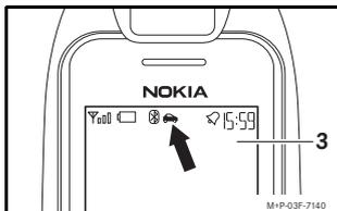
Im Display des Mobiltelefons erscheint ein kleines Fahrzeugsymbol (Pfeil). Ist dies nicht der Fall, Mobiltelefon (3) entnehmen und erneut einsetzen.
