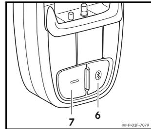
3. Bluetooth®-Taste (6) ca. 2 Sekunden drücken. Die Leuchtdiode (7) blinkt in schneller Frequenz.
