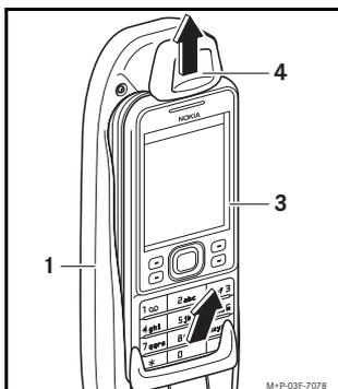
1. Verriegelung (4) nach oben schieben, und Mobiltelefon (3) aus dem Halter (1) nehmen.
