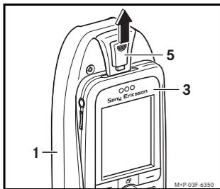
Entriegelung (5) nach oben schieben und Mobiltelefon (3) aus dem Halter (1) ziehen.
