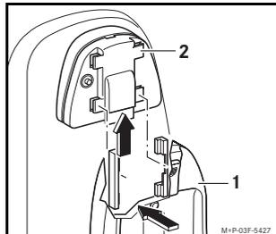
Halter (1) in die Arretierungen der vorinstallierten Halterung (2) drücken und nach oben schieben, bis er hörbar einrastet.
