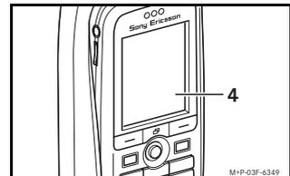
Auf dem Display (4) des Mobiltelefons erscheint die Meldung „Kfz-Profil“. Ist dies nicht der Fall, Mobiltelefon entnehmen (siehe unten) und erneut einsetzen.
