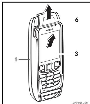
Verriegelung (6) nach oben schieben, und Mobiltelefon (3) aus dem Halter (1) nehmen.
