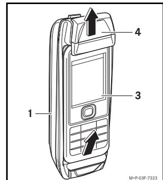
Verriegelung (4) nach oben schieben, und Mobiltelefon (3) wie abgebildet aus dem Halter (1) entnehmen.
