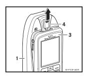
1. Verriegelung (4) nach oben schieben, und Mobiltelefon (3) aus dem Halter (1) entnehmen.
