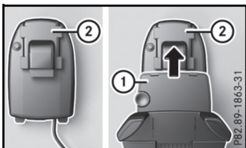
► 将智能手机托座 ① 推至中央控制台的接触板 ② 上。
