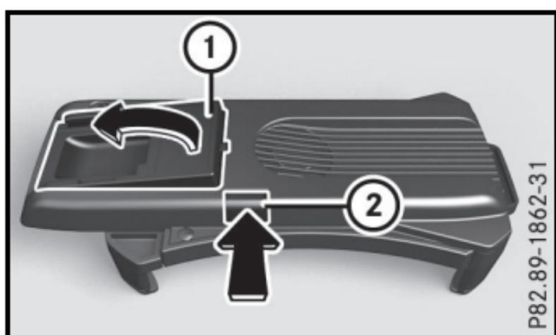
Si el soporte para smartphone está montado en posición vertical en el vehículo, puede ajustar el ángulo de orientación para un mejor manejo.
