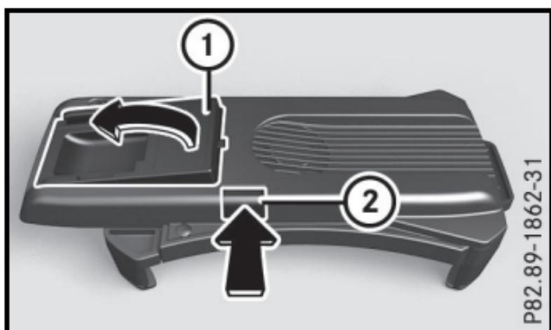
Se l'alloggiamento per smartphone è montato perpendicolarmente nel veicolo, è possibile regolare l'angolare di allineamento per un migliore impiego.
