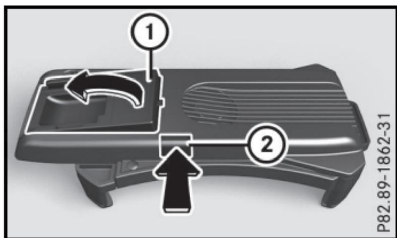
Если приемное гнездо для смартфонов установлено в автомобиле вертикально без наклона, то можно изменить положение выравнивающего уголка, чтобы телефоном легче было пользоваться.
