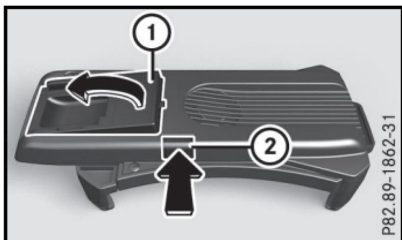
如果智能手机托座垂直安装在车上，则可调节定位角板以改善操作。
