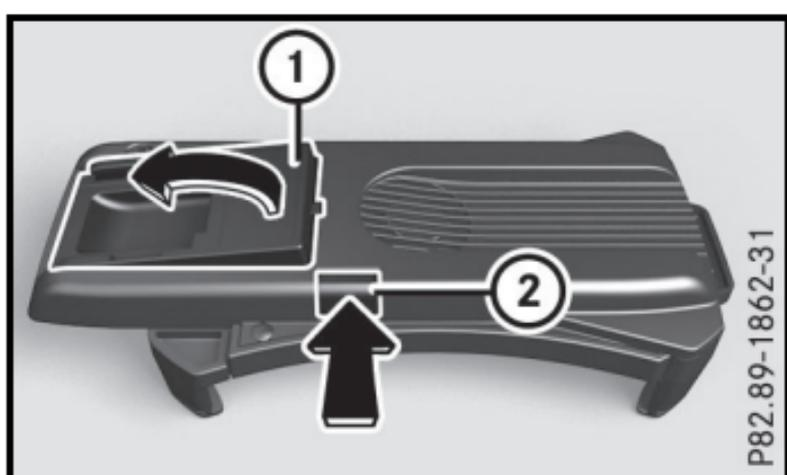
Pokud je držák instalován ve vozidle vzpřímeně, je možné úhel směřování pro lepší dostupnost změnit.
