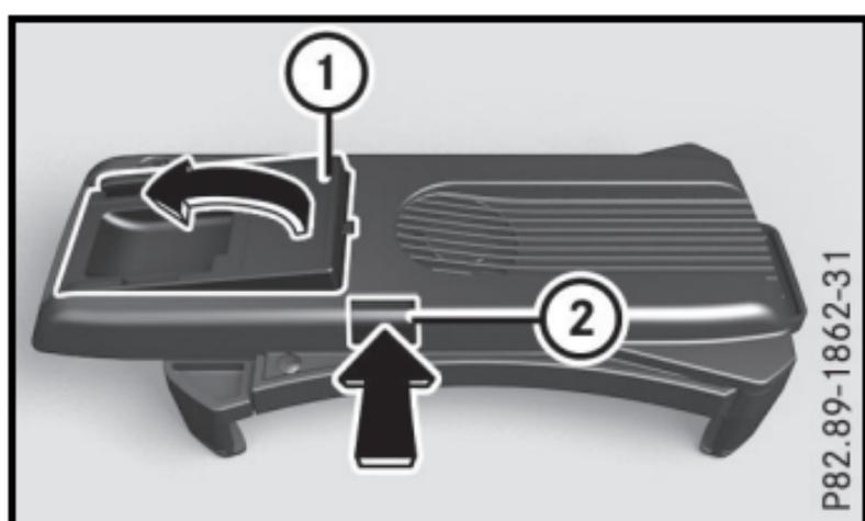
Si le réceptacle pour smartphone est monté à la verticale dans le véhicule, vous pouvez régler le support d'inclinaison pour un maniement plus aisé.
