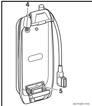
2. Bluetooth®-Taste (4) ca. 2 Sekunden drücken. Die Leuchtdiode (5) blinkt in schneller Frequenz.
