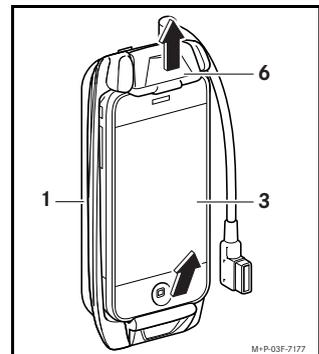
1. Verriegelung (6) nach oben schieben, und Mobiltelefon (3) aus dem Halter (1) nehmen.
