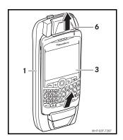
Verriegelung (6) nach oben schieben, und Mobiltelefon (3) aus dem Halter (1) entnehmen.
