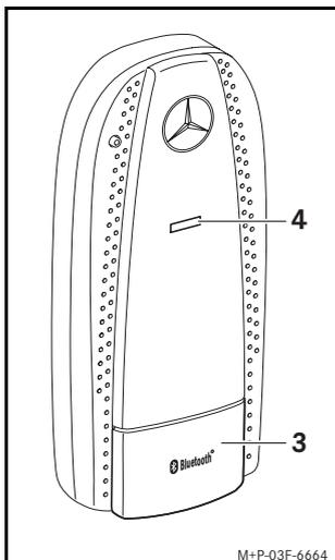
2. Am Telefon-Modul die Taste (3) ca. 2-3 Sekunden drücken. Die Leuchtdiode (4) blinkt in schneller Frequenz.
