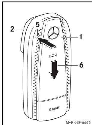
1. Entriegelungsknopf (5) drücken, Telefon-Modul (1) in Pfeilrichtung (6) nach unten schieben und von der Kontaktplatte (2) abnehmen.
