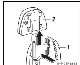
1. Telefon-Modul (1) auf die Kontaktplatte (2) schieben, bis es hörbar einrastet.
