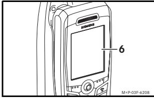
Auf dem Display (6) des Mobiltelefons erscheint eine Meldung (den genauen Wortlaut entnehmen Sie bitte der Betriebsanleitung des Mobiltelefons). Ist dies nicht der Fall, Mobiltelefon entnehmen (siehe Abschnitt „Mobiltelefon entnehmen“) und erneut einsetzen.
