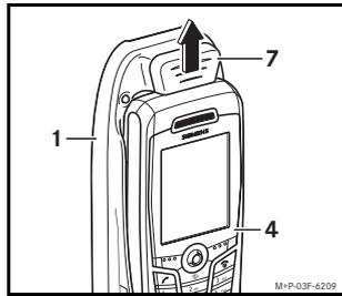
1. Entriegelungstaste (7) nach oben schieben, und oberen Teil des Mobiltelefons (4) aus dem Halter (1) ziehen. Anschließend Mobiltelefon (4) nach oben aus dem Halter (1) nehmen.
