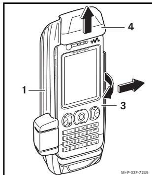
Verriegelung (4) nach oben schieben, und Mobiltelefon (3) aus dem Halter (1) entnehmen.
