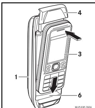
Mobiltelefon (3) auf die Kontaktfläche (6) aufsetzen und mit leichtem Druck oberhalb des Displays in den Halter (1) einrasten lassen.
