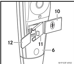
2. Abdeckung (10) unterhalb der Hörerschleife des Hörers (6) öffnen, SIM-Kartenhalter (11) nach rechts schieben und aufklappen.
