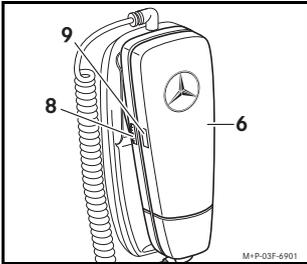
2. Am Hörer (6) Rändelrad (8) kurz drücken, ohne das Rändelrad (8) dabei zu verdrehen. Die Leuchtdiode (9) blinkt in langsamer Frequenz, im Display des COMAND oder Audio-Systems erscheint eine Meldung, dass das Telefon aktiviert wird. Das Telefon-Modul sucht und verbindet das jeweils zuvor gekoppelte Mobiltelefon.
