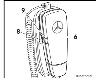
3. Am Hörer (6) Rändelrad (8) ca. 3 Sekunden drücken, ohne das Rändelrad (8) dabei zu verdrehen. Die Leuchtdiode (9) blinkt in schneller Frequenz. Im COMAND-Display erscheint eine Meldung, dass das Telefon aktiviert wird.
