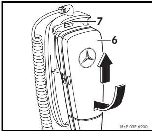
1. Hörer (6) oben in die Haltenase (7) einsetzen und unten drücken, bis er hörbar einrastet.
