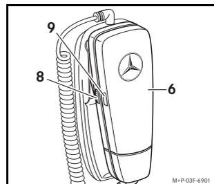
3. Am Hörer (6) Rändelrad (8) ca. 3 Sekunden drücken, ohne das Rändelrad (8) dabei zu verdrehen. Die Leuchtdiode (9) blinkt in schneller Frequenz, im Display des Audio-Systems erscheint WAIT . . .
