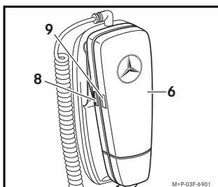
3. Am Hörer (6) Rändelrad (8) ca. 3 Sekunden drücken, ohne das Rändelrad (8) dabei zu verdrehen. Die Leuchtdiode (9) blinkt in schneller Frequenz, im Multifunktions-Display erscheint WAIT . . .
