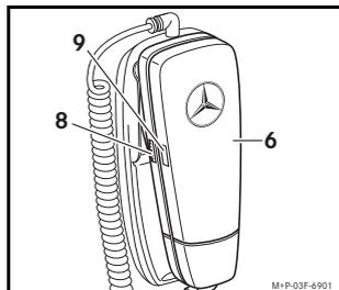
3. Am Hörer (6) Rändelrad (8) ca. 3 Sekunden drücken, ohne das Rändelrad (8) dabei zu verdrehen. Die Leuchtdiode (9) blinkt in schneller Frequenz. Im COMAND bzw. Audio-System erscheint eine Meldung, dass das Telefon aktiviert wird.
